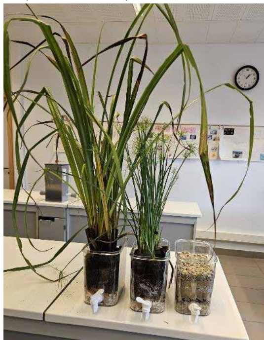
Composition des bacs d'épuration
